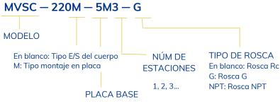
3B: 3 puertos (para E/S del cuerpo) 3M: 3 puertos (para montaje en placa)
